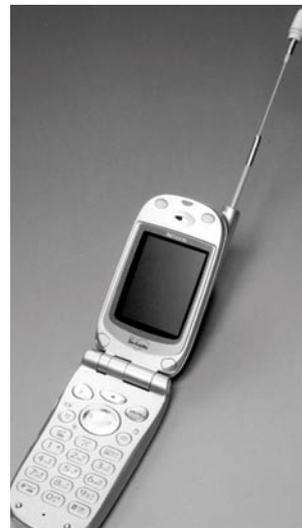
Figura 13: Una antena altamente flexible de cable de Ti-Ni. (NTT Mobile Communications Network Inc.)
